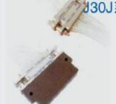
J30J系列微矩形电连接器，该产品插针接触件为绞线插针，间距为1.27mm特别适用于空间小的场合，多用于航空、航天电子设备及仪器。
