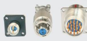
XC系列圆形电连接器，产品规格符合国军标GJB2889，采用双曲面线簧插孔，快速卡口连接，广泛应用于航天、航空、航海等领域。
